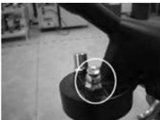
3. Um die Arbeitsgefahr zu vermeiden, darf die empfohlene Arbeitsdruck / Betriebsdruck NICHT über 10.34 Bar (150psi) sein.
