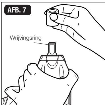
**LET OP:** De wrijvingsring, met een zekere plasticiteit en sterkte, helpt te voorkomen dat de dop tijdens het gebruik losraakt van de uitgaande aandrijving van de slagmoersleutel.
