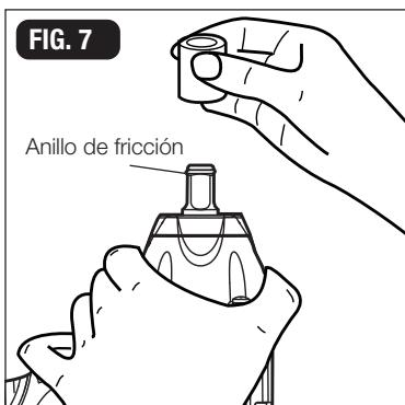
**NOTA:** El anillo de fricción, ayuda a evitar que el vaso se desenganche del cuadrado conductor de la llave de impacto durante el funcionamiento.
