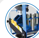
Lierbescherming en katrolbescherming voor uw handvei- ligheid
