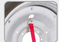
Supporto di sicurezza robusta per un rapido fissaggio della ruota durante il trasporto
