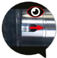
Anello con spia per seguire passo dopo passo l'avanzamento dell'estrazione.
