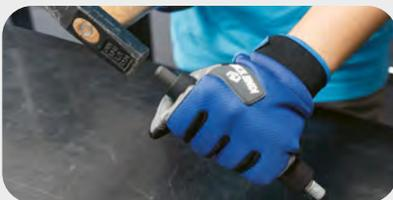
Bussole progettate per i bulloni usurati o arrotondati nel tempo. Chiavi a bussola in SNCM (Silicio Nichel Cromo Molibdeno).
