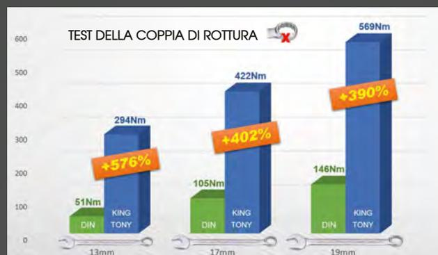
Risultati del test eseguito dal CETIM (organizzazione di certificazione indipendente). Test del momento torcente di rottura delle chiavi combinate KING TONY® da 13, 17 e 19 mm, confrontato con la norma DIN 3113.
