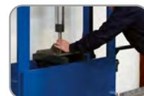
Velocità elevata a comando pneumatico doppio effetto con l'utilizzo del piede ed entrambe le mani libere per un posizionamento rapido e preciso.
