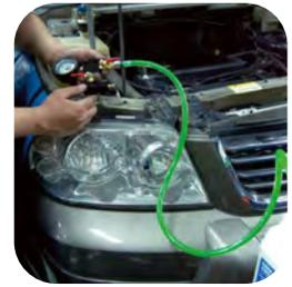
Consente una sostituzione rapida del liquido di raffreddamento sotto-vuoto.
