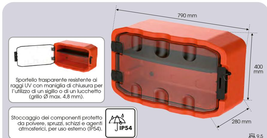
Sportello trasparente resistente ai raggi UV con maniglia di chiusura per l'utilizzo di un sigillo o di un lucchetto (grillo Ø max. 4,8 mm).
